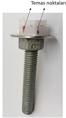
Şekil 1 M8x1,25 DIN 933 cıvata için torklama testi sonrası temas alanlarının belirlenmesi
