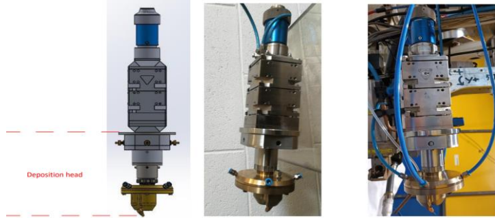
Şekil 8 Lazer ve biriktirme kafasının tasarımı ve montajlanmış hali
