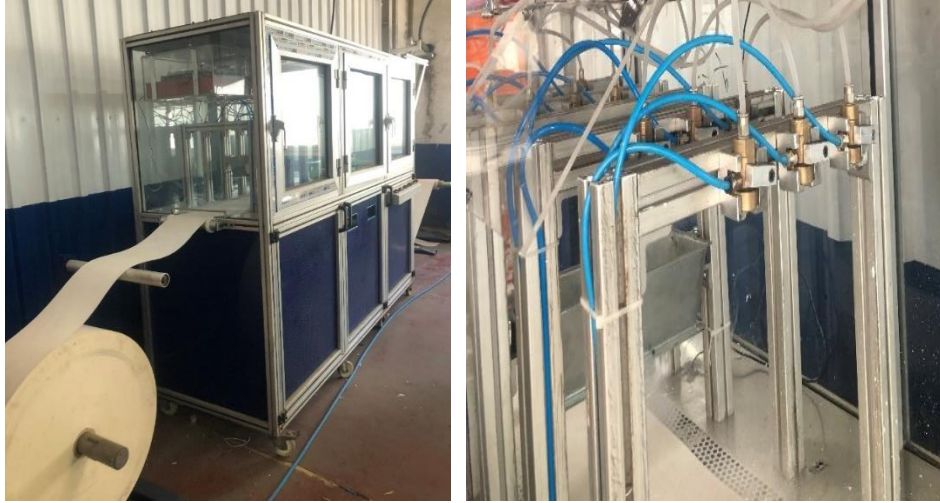
Şekil 3. Kesiksiz Çözelti Üfleme Cihazı ve Düze Kollektörleri
