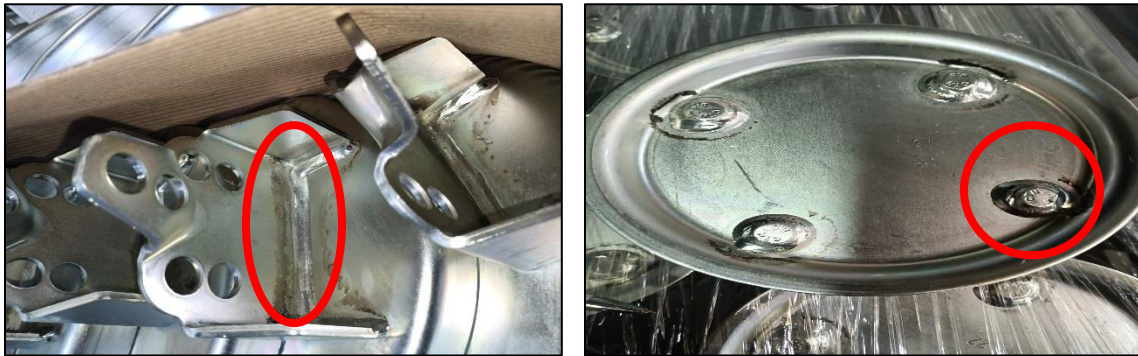
Şekil 2: Kaynak esnasında görülen harelenme hataları
