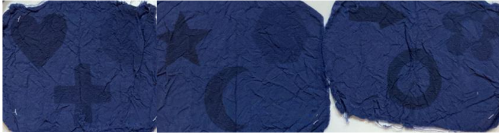
Şekil 2: Lazer ile susuz desenlendirilmiş %100 yün kumaş örnekleri
