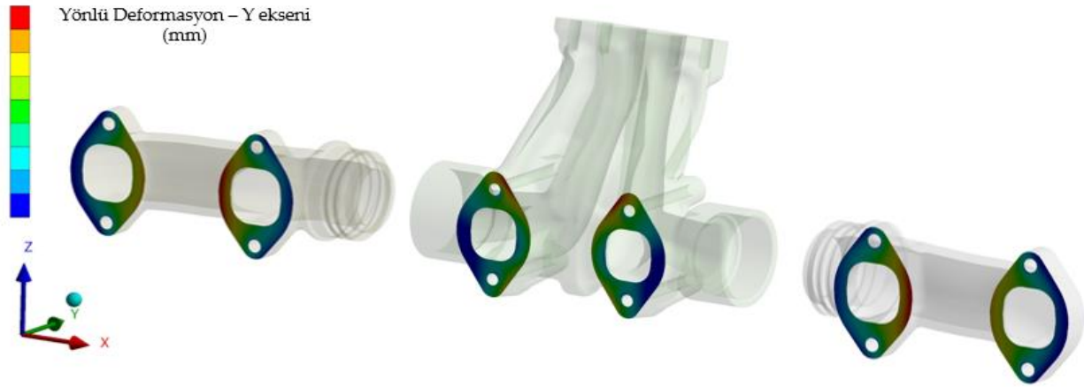
Şekil 11: Egzoz Manifoldu Yönlü Deformasyon Sonuçları
